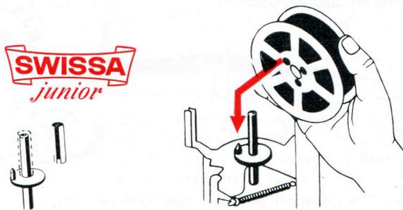
Beim Einsetzen des neuen Farbbandes beachten, daß der mit Pfeil ange deutete Mitnehmerstift in eines der Spulenlöcher kommt. Beim Gebrauch englischer oder amerikanischer Farbbandspulen ist die Hülse auf der Spulenachse abziehen. Für Normalspulen nach DIN darf die Hülse nicht entfernt werden.
