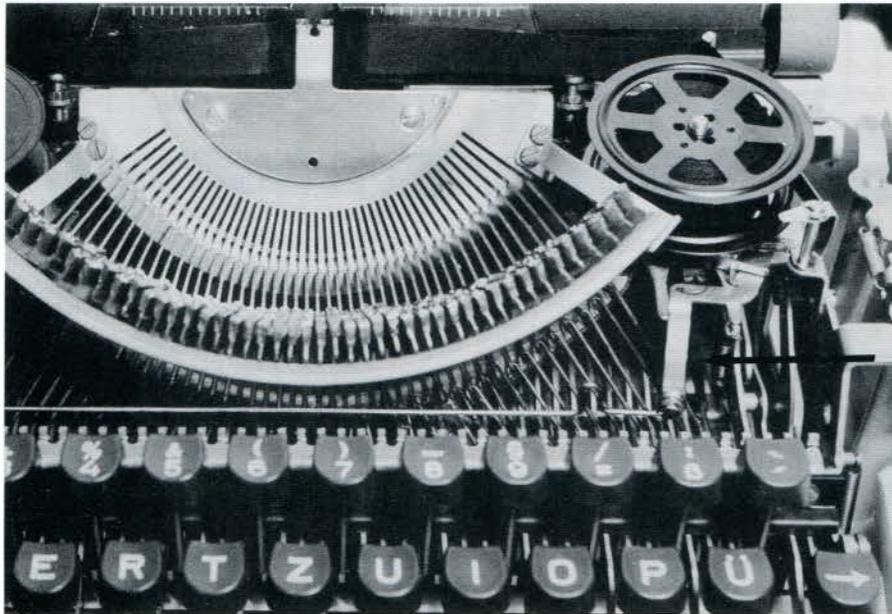
3. Farbbandhaltebügel der linken Spule durch Druck in Pfeilrichtung ausschwenken; linke Farbbandspule von der Achse abziehen.
